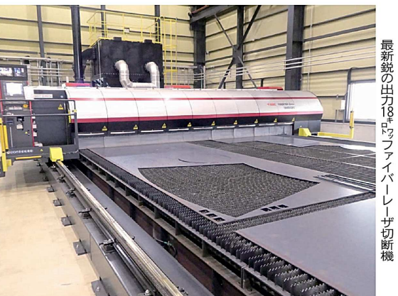
最新鋭の出力18キロワットファイバーレーザー切断機
